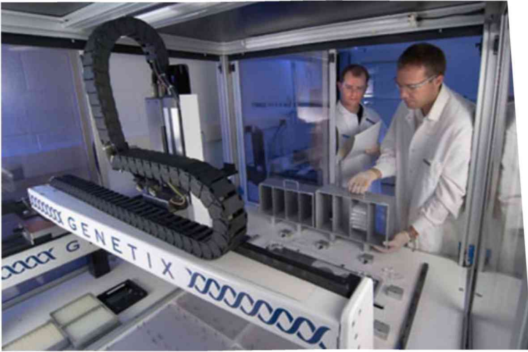
Figura 4.3. Robot de microarreglos de la marca Genetix, similar al que existe en el laboratorio de Davidson en Caltech. El «martillo» tiene la capacidad de automatizar por completo los procesos que necesarios con un alto rendimiento. El sistema puede purificar y normalizar 800 plásmidos en aproximadamente seis horas.
