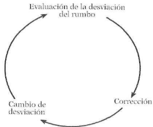
Figura 4-2 Bucle de retroalimentación en el pilotaje de una embarcación.
