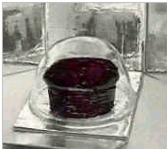
Figura 2. Efecto invernadero en un panel Solar Bernard, creado con un cuenco de cristal.
