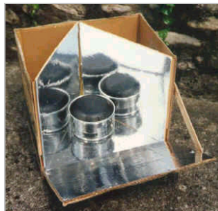
Figura 7. Panel Solar construido a partir de una caja de cartón
