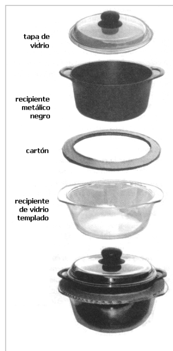
Figura 3. Recipiente con efecto invernadero inferior, diseño de Roger Bernard.
