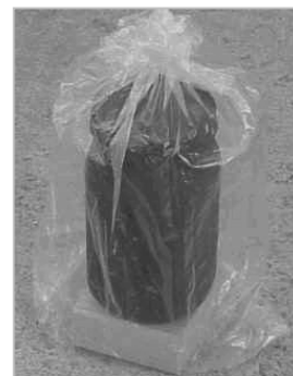
Figura 1. La bolsa plástica rodea el recipiente para provocar el efecto invernadero fuera de él.
