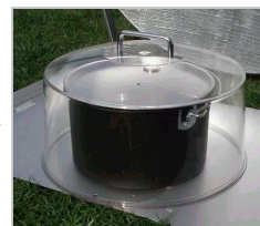
Figura 12. Cubierta plástica para crear el efecto invernadero en un recipiente de cocción.
